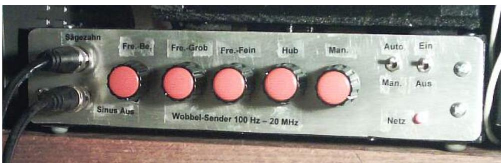
*Die Frontseite des Wobblergenerators (Wobbelsenders). Auf der Rückseite befindet sich noch ein Anschluss für den Frequenzzähler. Die Beschriftung erfolgte mit einem Tintenstrahldrucker und einer dafür geeigneten Klarsichtfolie.*
