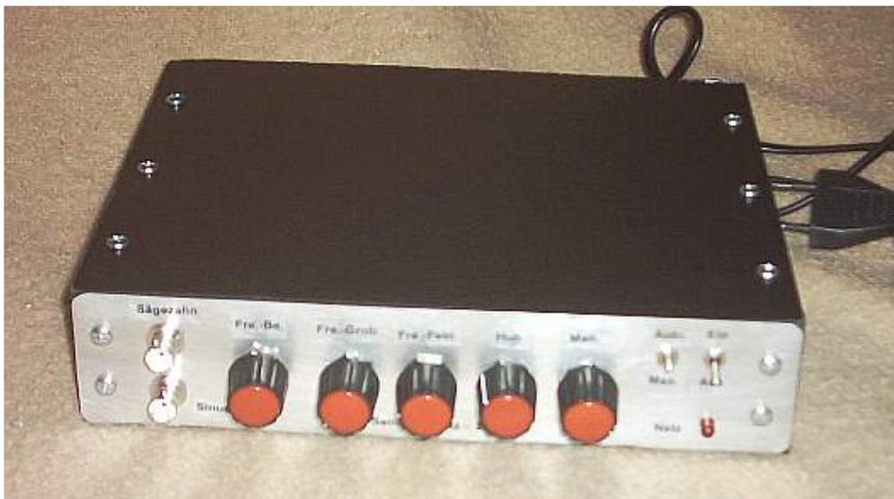
*Der Wobbelgenerator (Wobbelsender) passt in ein Gehäuse mit den Abmessungen: Breite 13 cm, Tiefe 19 cm, Höhe 5 cm.*
